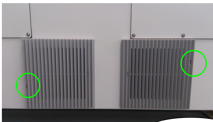
ファンカバーの爪位置確認
